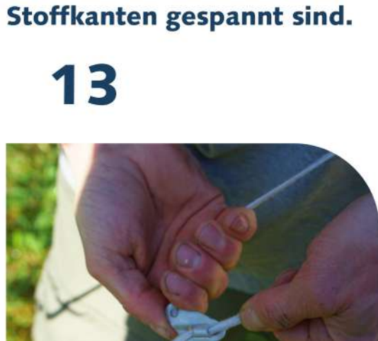
AZ mit Dreilochspanner nachspannen bis es faltenfrei ist.
